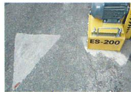
Peler, enlever, gratter du thermoplastique, époxy, résine sur béton et asphalte, bandes de signalisation.
