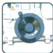
**4. Réglage de coupe** au millimètre près par la manivelle de réglage
